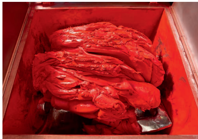
Bild 3. Abhängig von Dispergierhärte und Empfindlichkeit des Wirkstoffs wird die Dispergiertechnologie, wie etwa Kneten, gewählt. So lassen sich auch Nanofüllstoffe oder empfindliche Flitterpigmente in eine Masterbatch-Präparation einarbeiten (© CIS)
