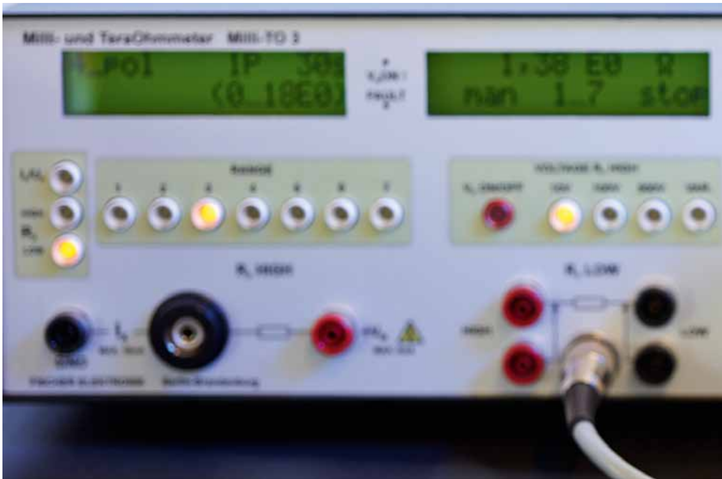
Die Leitfähigkeit der hochgefüllten Compounds wird über Leitfähigkeitsmessungen ermittelt. Bild: Caparol
