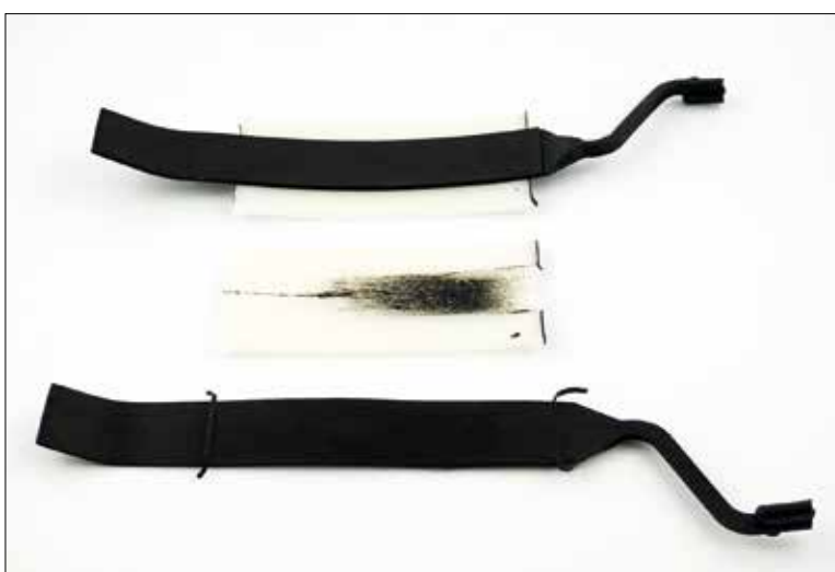
Bild 5: Abrissverhalten der angespritzten Rußcompounds von PP (oben) und PA6 (unten) im Rollschälversuch.
