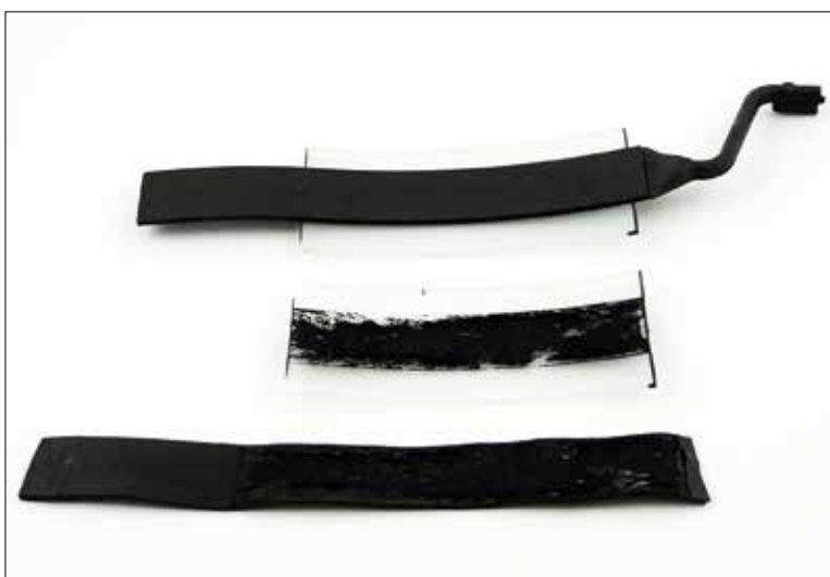
Bild 4: Gegenüberstellung der Fließweglängen der Compounds aus Bild 3 im Vergleich zu einem PP Homopolymer in einer Fließspirale von 2 mm Dicke bei gleichen Spritzgießbedingungen. Die Ergebnisse korrespondieren mit denen in Bild 3 und verdeutlichen den starken Einfluss der Viskosität auf den erreichbaren Füllgrad.
